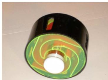
C'est sans doute la machine la plus délicate à étudier. La forme particulière des ailettes qui constituent le corps principal de la machine permet de décaler le point d'application de la force exercée par le gaz par rapport au centre d'inertie. Le déséquilibre ainsi créé est donc maintenu pendant la rotation de la machine.
