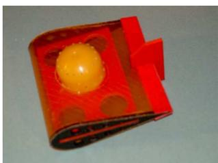
Puisque le concours du scénario impose de faire avancer une machine, il a fallu ajouter une aile inclinée autour de l'œuf pour faire agir les forces de frottement dans l'eau. On utilise ainsi le mouvement vertical du dispositif pour créer une nouvelle force introduisant une composante horizontale. L'aile est double de manière à ce que l'effet du mouvement descendant n'annule pas l'effet du mouvement ascendant.
